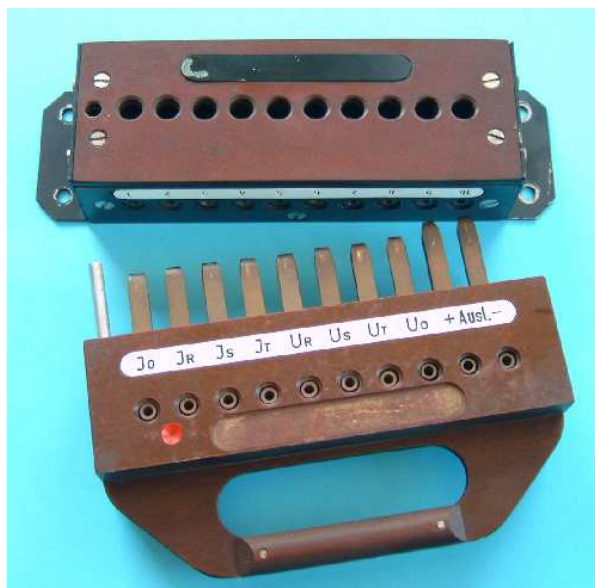
Bild 25: Prüfleiste und Stecker, wie er vor mehr als 40 Jahren mit der Uni Dresden entwickelt wurde
